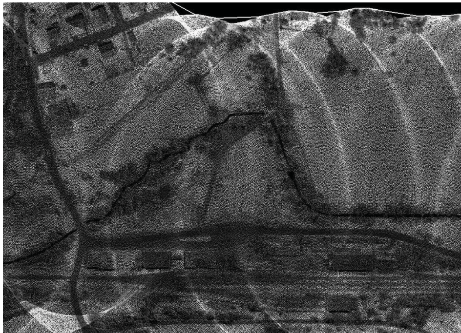
Obr. 3 - Ukázka dat z leteckého laserového skenování – podklady pro přeložku R55 v kontaktu s železniční tratí
